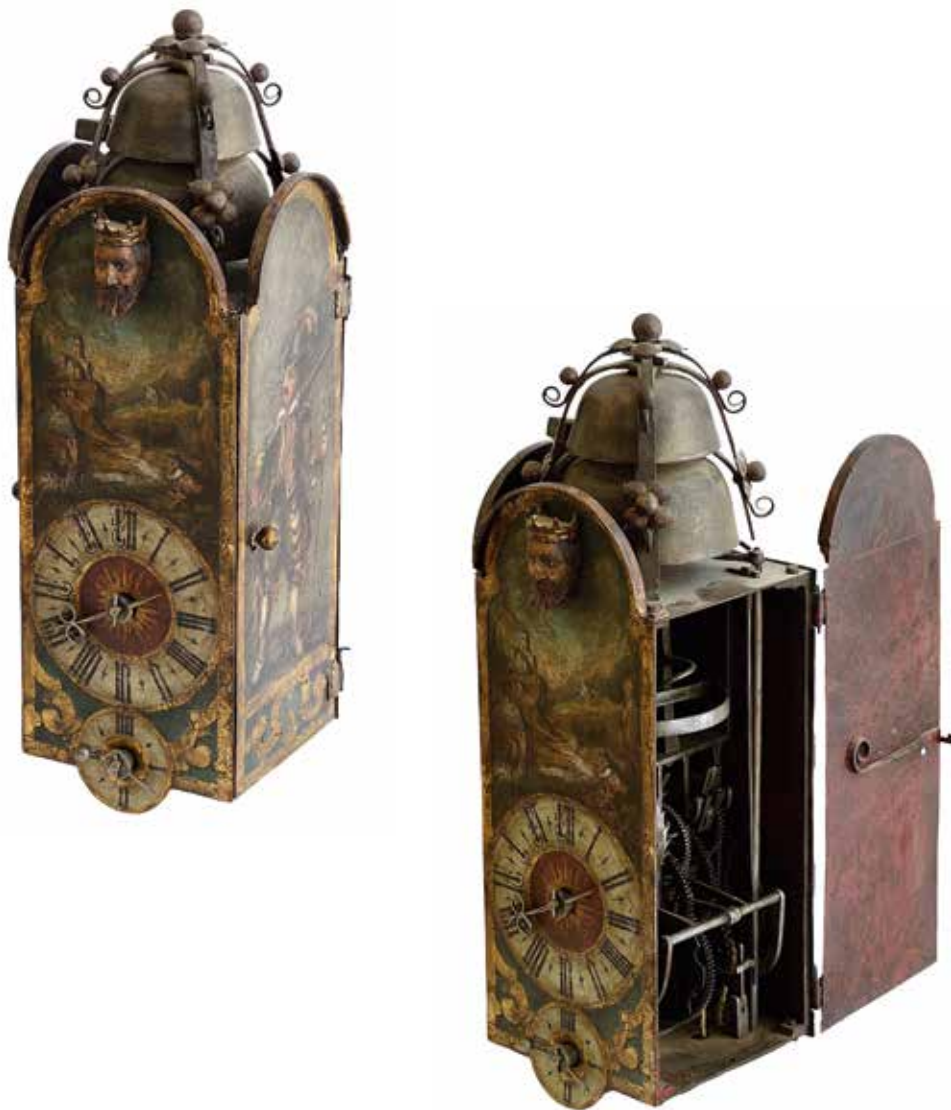
1 ZEIGRIGE EISENUHR, Stundenschlag auf Glocke mit Automat, 17. Jh. Polychrom bemaltes Gehäuse. Auf Seitentüren Figuren in Mittelalterlichem Kostüm, Front mit Burglandschaft. Im Fronton aufgesetzter Königs-kopf. Beim Stundenschlag öffnet und schliesst er seinen Mund. Bemalter Zifferring, geschmiedeter Lilienzeiger, darunter Viertelstunden-Kontroll-scheibe. Eisen-Spindelwerk mit schmalen Eisenrädern, zurückgebaut auf Radunruh, Schnur-Gewichtszug. Restaurationen und Ergänzungen. H = 44,5 cm. Sehr dekorative, frühe Eisenuhr. 3800.–/5500.–
